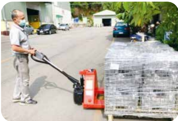
▲ 改採電動升降堆高機執行後較容易搬運
