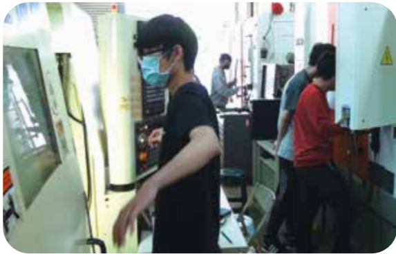
▲ 與國立屏東科技大學合作產學訓（電腦輔助設計與製造班），學員於電腦數值控制車床實習操作機臺
